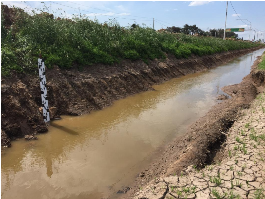
Imagen n°1: Limnómetro o regla de medición de carga hidráulica del canal.
